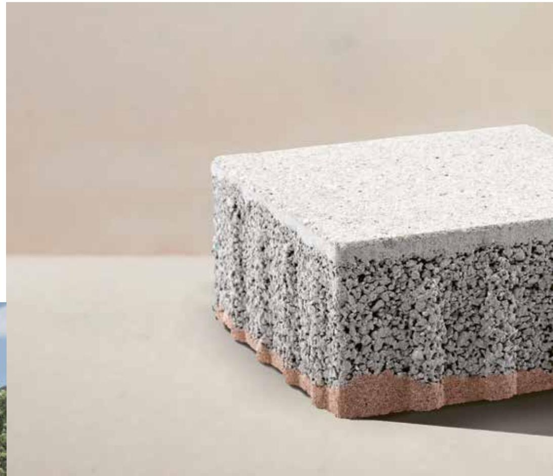
*D Der Klimastein ist bereits in der Herstellung ressourcenschonend, seine besonderen Umwelteigenschaften entfaltet er aber im Einsatz. Durch seinen innovativen Aufbau wird die Versiegelung der Fläche vermieden. Der Stein speichert Wasser, lässt überschüssiges versickern und durch Kapillarwirkung später verdunsten. Nicht zuletzt auch ein wertvoller Beitrag zur Kühlung unserer Städte.*
