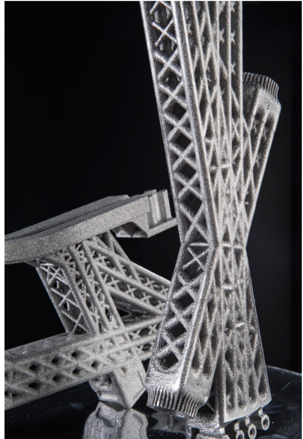
DE „Airbus zeigt mit der Bionischen Trennwand in beispielhafter Weise auf, welche Möglichkeiten generative Fertigung bietet. Im Flugverkehr bedeutet die erreichte Gewichtsreduktion um 45% eine enorme Kraftstoffersparnis. Die ast-ähnlichen Strukturen bieten einen Ausblick auf das formal-ästhetische Potential der topologischen Optimierung.“
